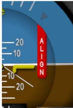
*Figure 28 - Aligning Annunciator*
