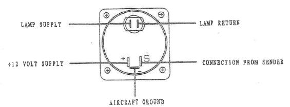
NOTE: SENDING UNIT MUST BE GROUNDED FOR PROPER OPERATION WIRE ACCORDING TO MARKS ON CONNECTOR, CONNECTOR MAY BE ROTATED FROM ORIENTATION AS SHOWN.
