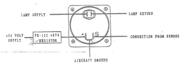
NOTE: SENDING UNIT MUST BE GROUNDED FOR PROPER OPERATION WIRE ACCORDING TO MARKS ON CONNECTOR, CONNECTOR MAY BE ROTATED FROM ORIENTATION AS SHOWN.
