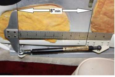
7. NOTE: DOOR BRACKET MUST NOT BE CLOSER THAN 8" FROM THE AIRFRAME BRACKET.
